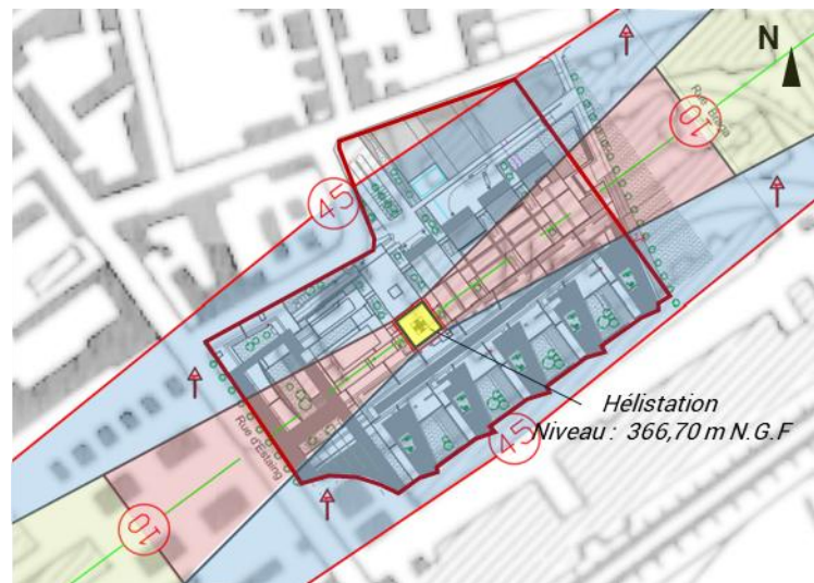
Dégagement suivant l'envol des hélicoptères, valeurs représentant le dégagement par rapport au niveau de l'hélistation
